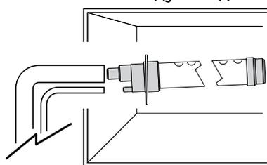
DP\*: каналный парораспределитель (вх. Ø 22, 30, 40 мм)
