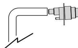
SDP\*: пластмассовая форсунка производительностью до 18 кг/ч
